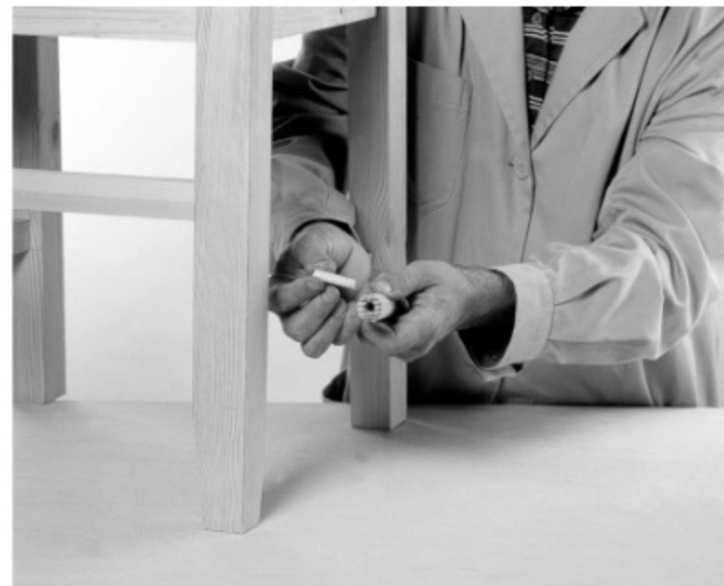
Fig. 49. Detalle de las clavijas de haya de 8 mm y de su colocación en las barretas del respaldo
