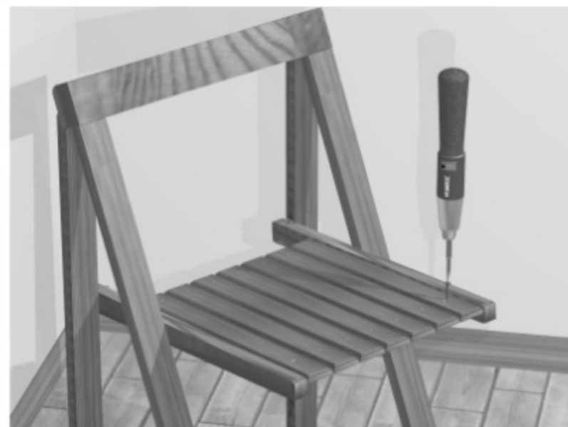
Fig. 107. Atornillado de las tablillas
