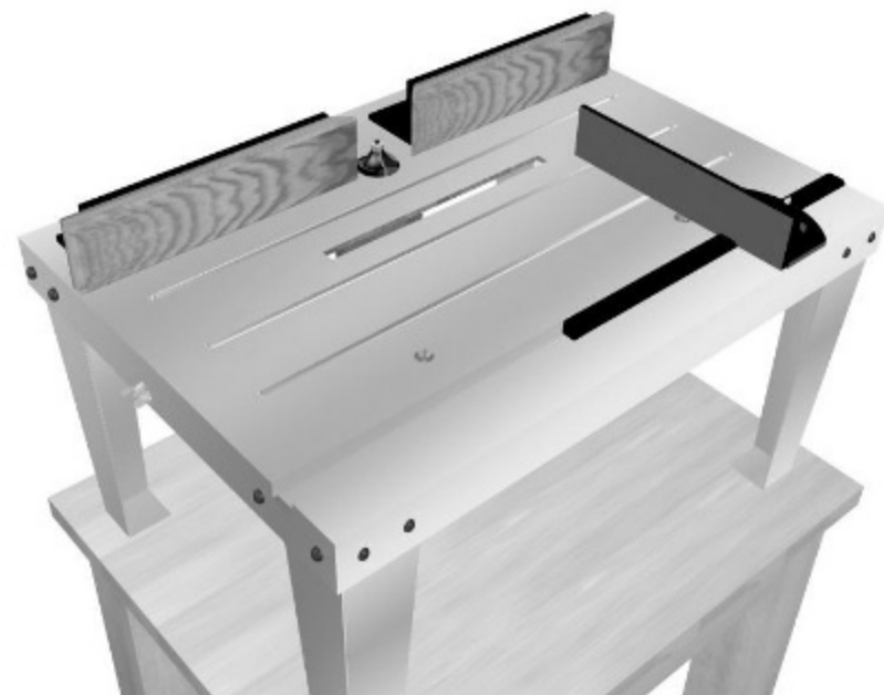
Fig. 17. Empleo de la fresadora de forma estacionaria como si fuese una pequeña tupí
