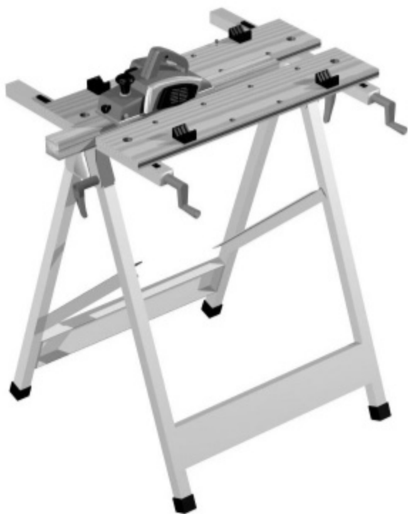
Fig. 5. Banco de trabajo plegable. Las mordazas sujetan la madera para pulirla con el cepillo eléctrico
