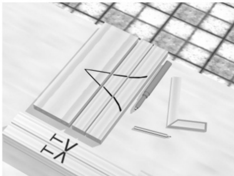
Fig. 42. Travesías unidas y marcadas con el signo convencional A
