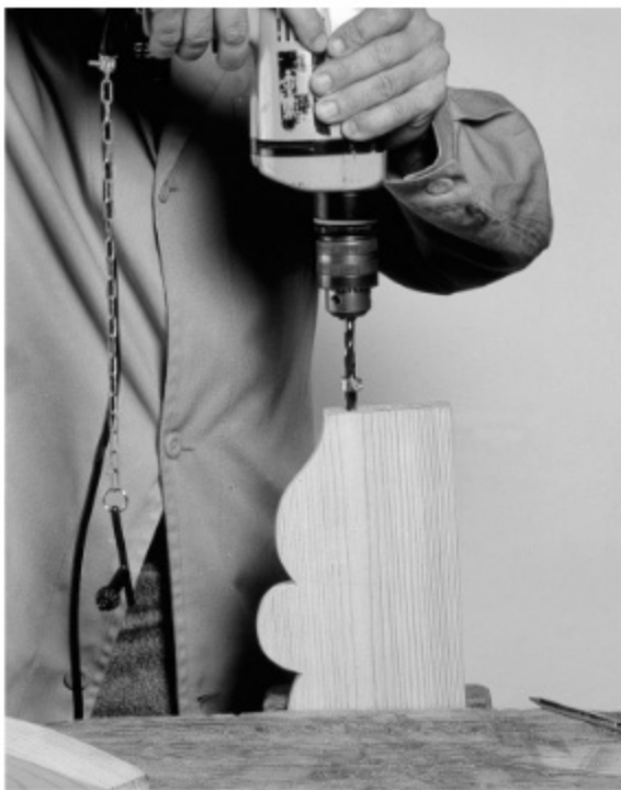
Fig. 48. Al taladrar a pulso, hay que colocar un limitador de profundidad
