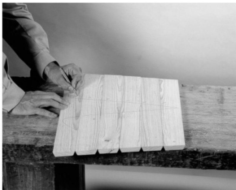
Fig. 58. Para la realización del asiento de tablillas, es necesario marcar la posición que deberán ocupar las tablillas cuando se atornillen
