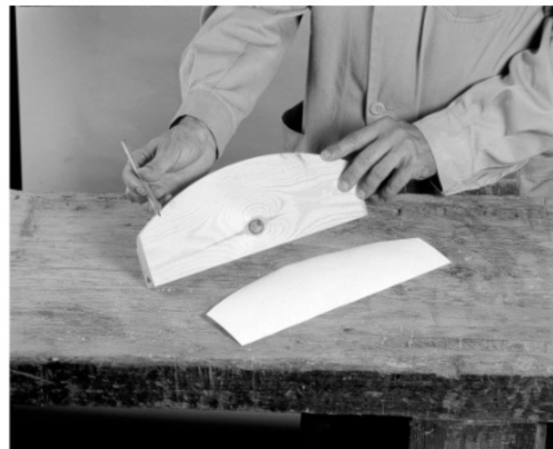
Fig. 53. También es necesario comprobar que la plantilla del respaldo coincide con la pieza, ya cortada y perfilada
