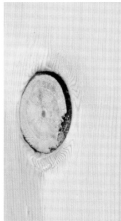
Fig. 25. Al seleccionar las piezas, deben rechazarse las que tengan nudos saltadizos
