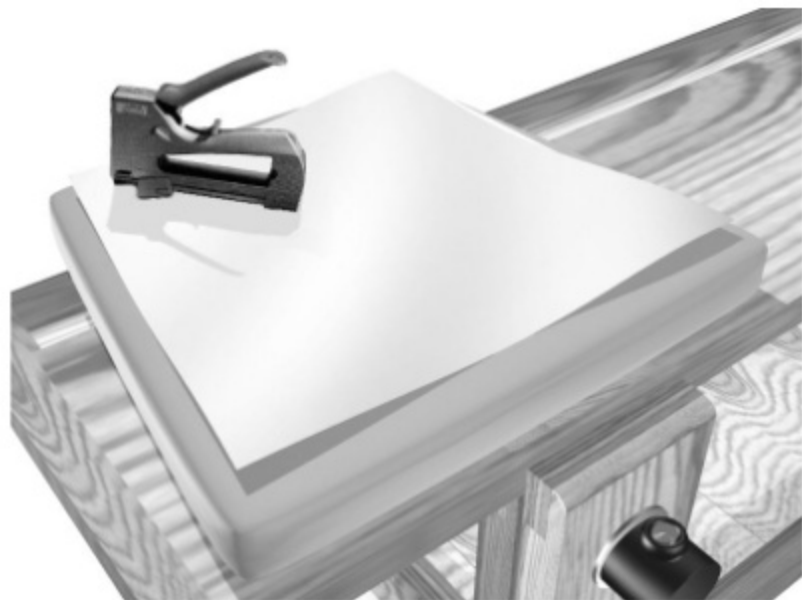
Fig. 82. Grapado del revestimiento de tela blanca en la cara posterior del asiento
