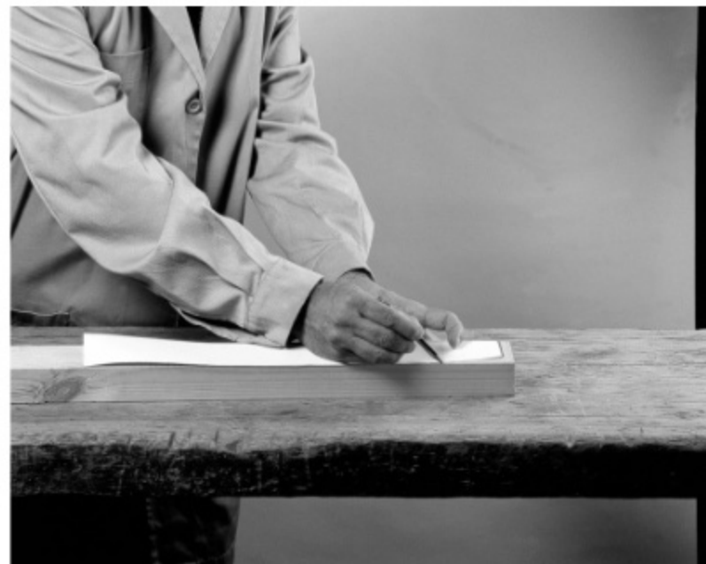
Fig. 44. Empleo de la plantilla recortada de las patas
