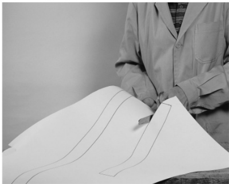
Fig. 39. Recorte de la plantilla de cartulina correspondiente a las patas traseras y delanteras
