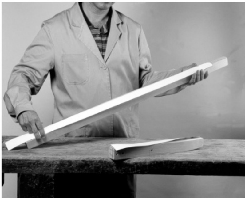
Fig. 45. Es preciso comprobar que las patas recortadas coincidan con las plantillas
