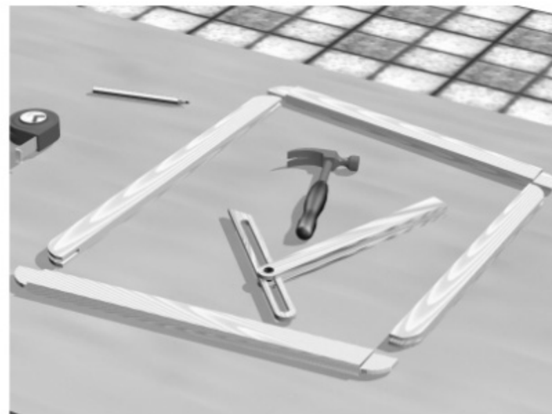
Fig. 79. Detalle del ensamblaje del bastidor necesario para tapizar el asiento
